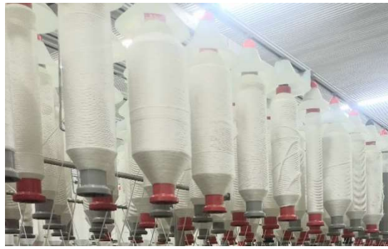
Gambar 2 menyiapkan bobbin roving
